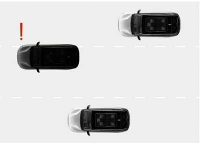
Ostrzeżenie przed niezamierzoną zmianą pasa ruchu (LDW) System ostrzegający z wyprzedzeniem kierowcę w sposób dźwiękowy o wykryciu ryzyka bezwiednego najechania na linię rozdzielającą pasy ruchu.
